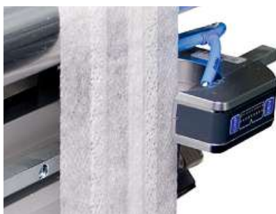
Infrared edge sensor FR 46 on non-woven fabric edge
